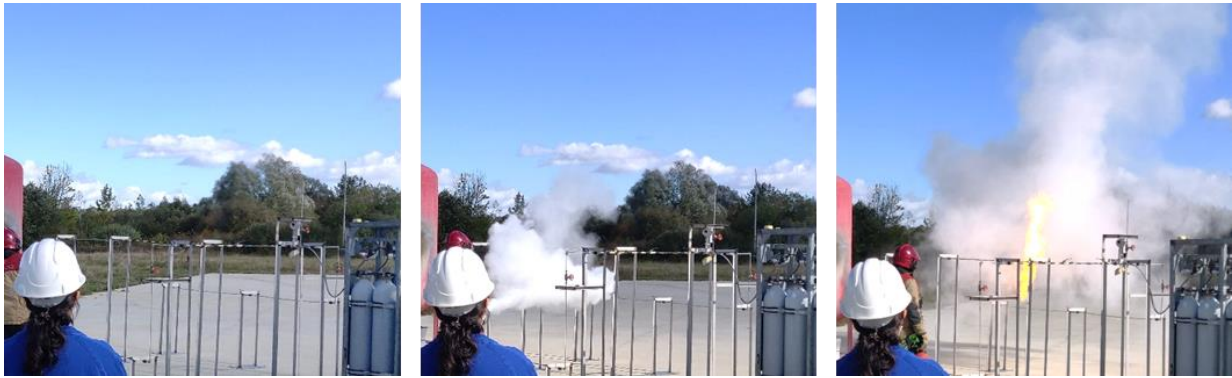
Fig. 5. Fuite d'hydrogène enflammée, révélée par la poudre d'un extincteur.
