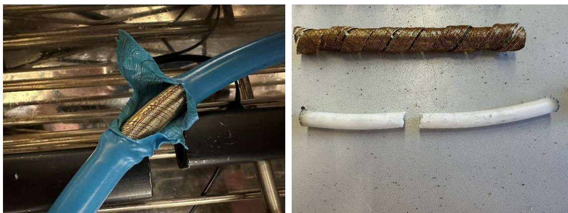
Fig. 7. Le flexible après sa rupture (à gauche : dans la chambre d'essai ; à droite : après avoir retiré les fils d'armature métalliques) d'après [36]
