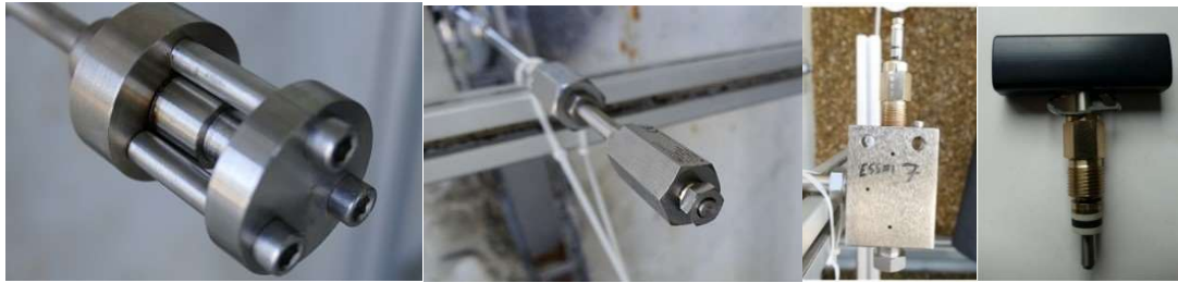
Fig. 10. De gauche à droite : la maquette de l'extrémité serrée d'un tuyau, un raccord non serré, une vanne mal montée et le système d'étanchéité d'une vanne
