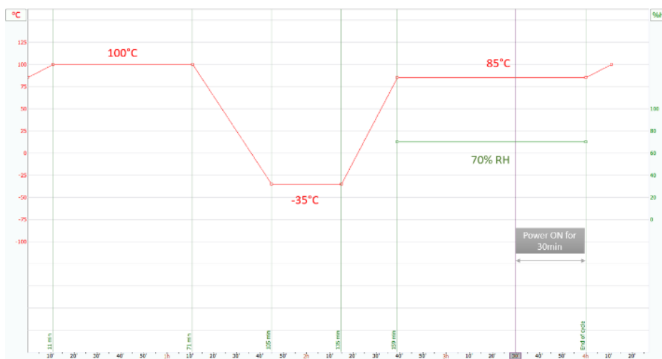
Fig. 1. Cyclage thermique pour les chips résistifs (un cycle).
